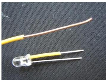
Isoliere 1,5cm vom gelben Draht ab und schiebe die Isolation über das längere Beinchen der LED. Platziere sie in deiner Holzform.
