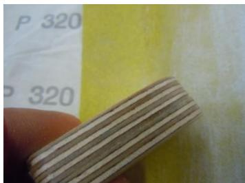
Schleife alle Kratzer mit dem 120/220 und 320 Schleifpapier weg. Danach kannst du es an der Schwabbelscheibe aufpolieren.
