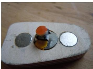
Die Batterie kannst du mit Isolierband abkleben, damit sie keinen ungewollten Kontakt mit dem Schalter macht. Mit **ganz wenig** Sekundenkleber kann ein Schaumstoff oder Rundholz auf den Schalter geklebt werden.
